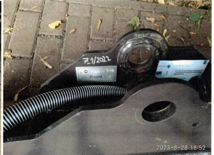
100 cm-es kanál adapter, hidraulikusan szögbe állítható
