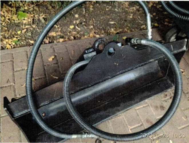
100 cm-es kanál adapter, hidraulikusan szögbe állítható
