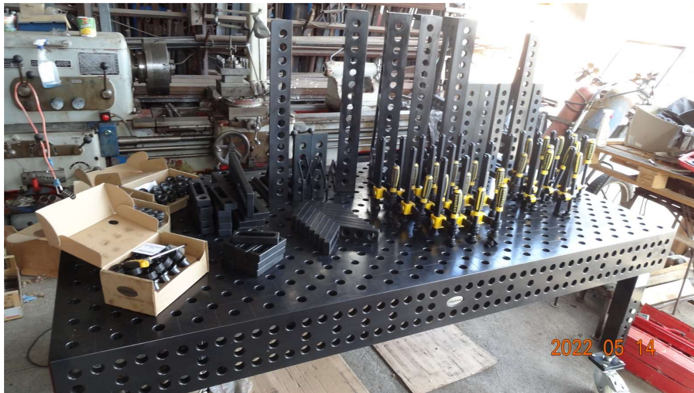
S28 Professional Extreme 8.7 2,4 x 1,2 m hegesztőasztal és készülék rendszer
