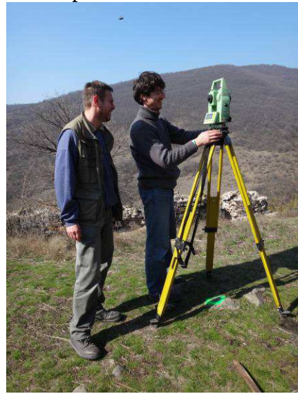
8-9. A Leica TPS 1105 mérőállomás a 4. alapponttal, és a mérőállomás használata
