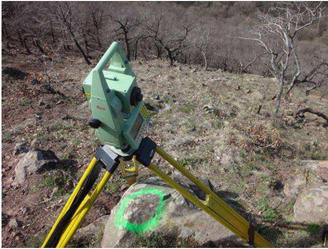
8-9. A Leica TPS 1105 mérőállomás a 4. alapponttal, és a mérőállomás használata
